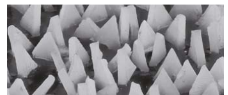
Orientación óptima del grano abrasivo VICTOGRAIN
