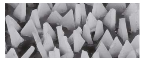
Orientación óptima del grano abrasivo VICTOGRAIN
